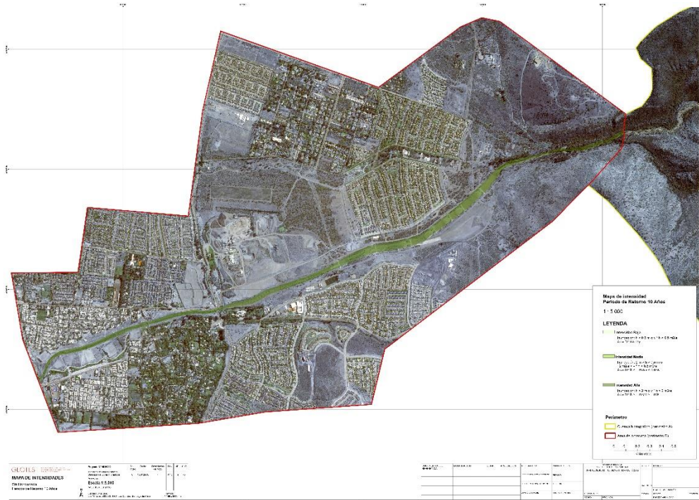
FIGURA N° 4-1 Mapa de intensidad en la quebrada de Macul para un periodo de retorno de 10 años.
