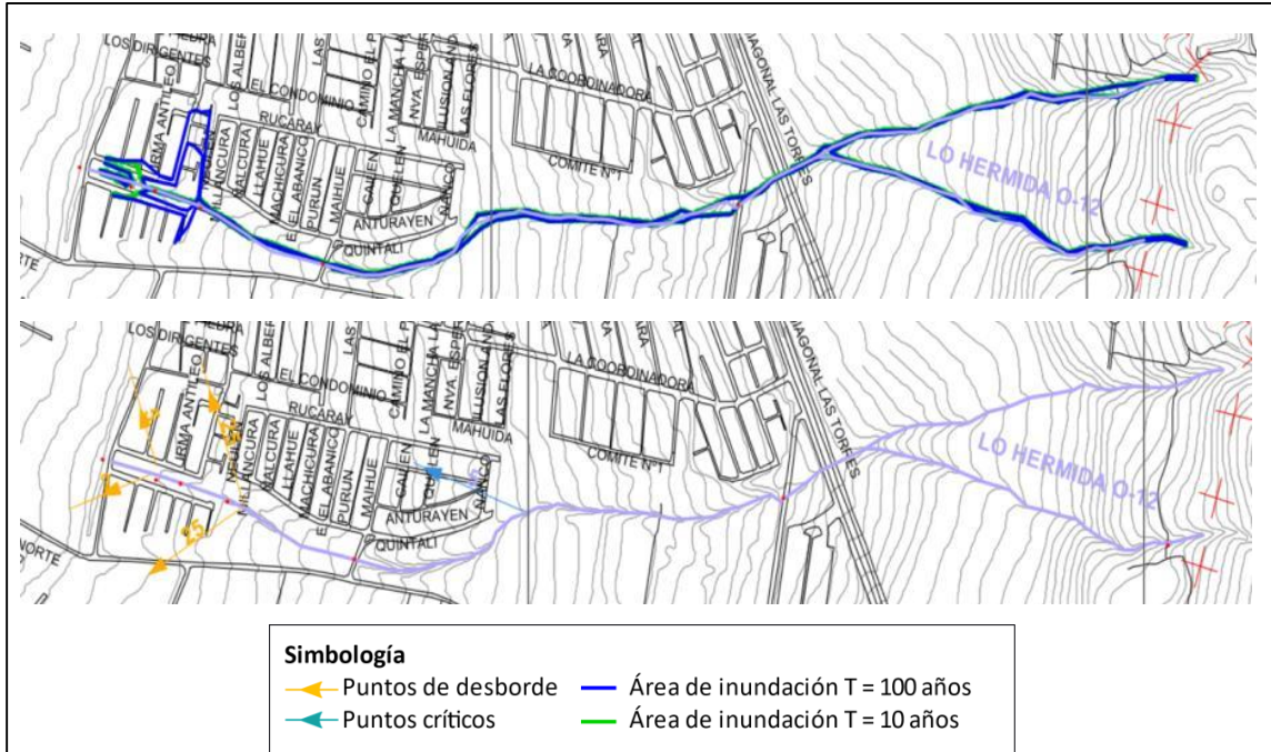
FIGURA N° 2-14: Área de inundación y puntos de desborde en la Quebrada Lo Hermida.
